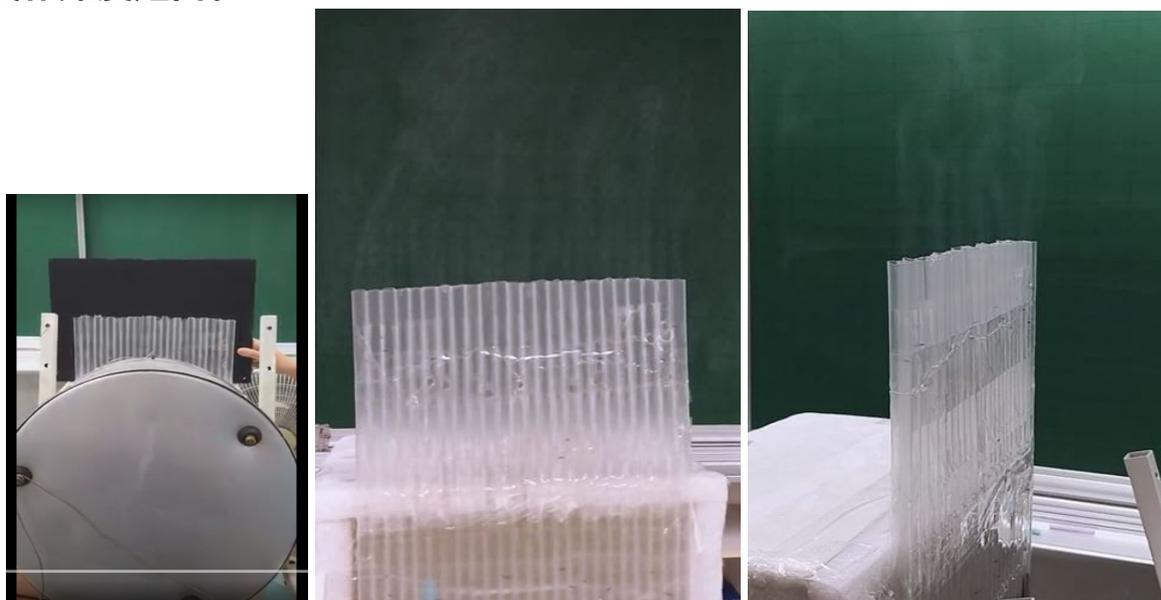
照片4-1-2 管簾管徑2cm對最佳對流速率管長的直流煙霧
