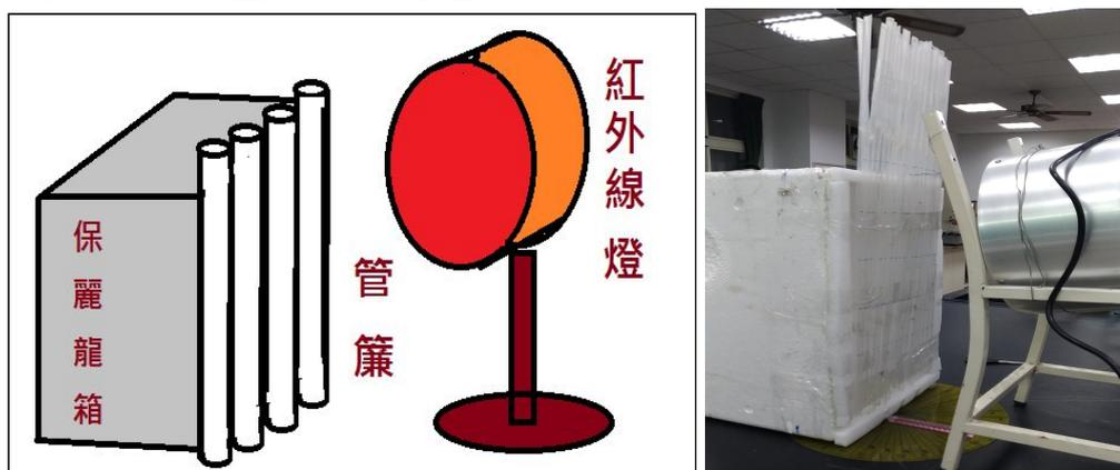
圖4-1-4-1 管長對管內氣體對流速率實驗裝置設計圖及實驗裝置
