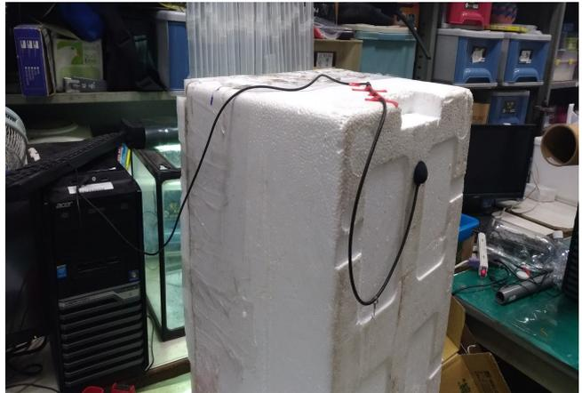
照片4-2-1-1噪音入射角對管簾隔音測量裝置
