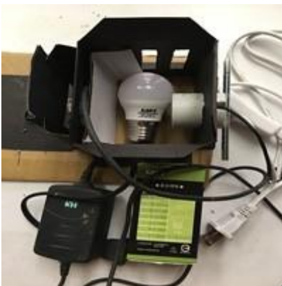
插上光源測試，發現光經凸透鏡折射路徑偏移
