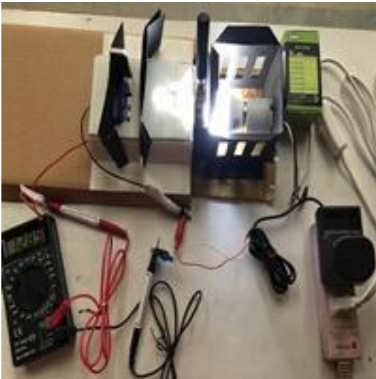
白織 LED 燈光源比色管底盤上提 3 cm 白織 LED 燈光源比色管底盤上提 2 cm 或 1 cm 光敏電阻端的六段式電壓切至 12V 電壓接受光源的照射比較
