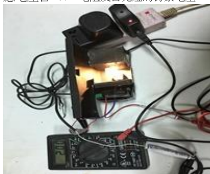
9V 電源下光敏電阻照 5V LED 燈的光感應電壓含背景電壓
