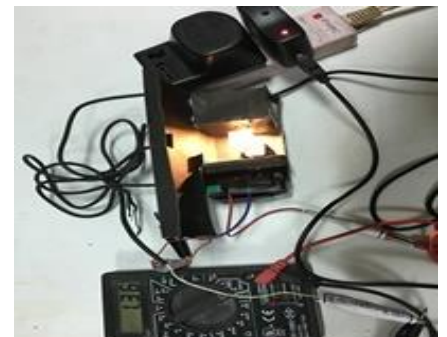
6V 電源下光敏電阻照 5V LED 燈的光感應電壓含背景電壓
