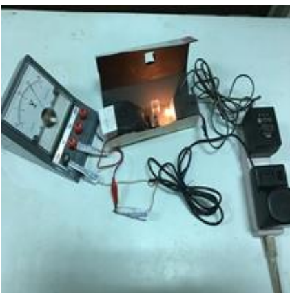
變壓器切至 3~12V 電源，以伏特計測試光敏電阻受到 7.5V 3w 燈泡的電源照射的感光後電壓變化
