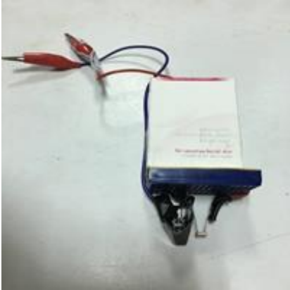
5mm 18KΩ 光敏電阻與綠光 LED 在麵包板上串聯加接線夾後，LED 遮光，麵包板固定在方型空盒上
