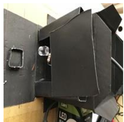
超亮白光 3w 串接 50Ω 電阻在麵包板上，麵包板貼在雙層黑色圖畫紙上，折成可放入光源出口的地方，調整聚焦在光敏電阻上。
