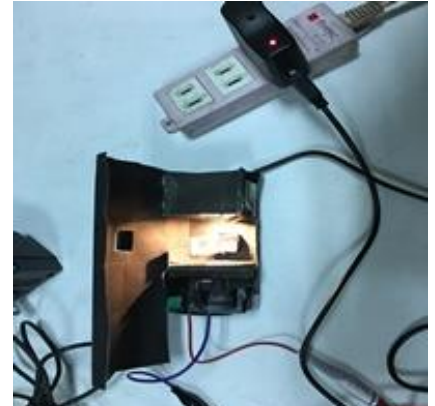
5V LED 整流電源插在一般 110 V 的延長線插孔上通電測試光路徑
