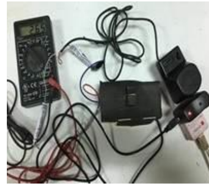
比色管加蓋，12V 電源下光敏電阻照 5V LED 燈的光感應電壓含 180Ω 電阻及不含日光燈的背景電壓
