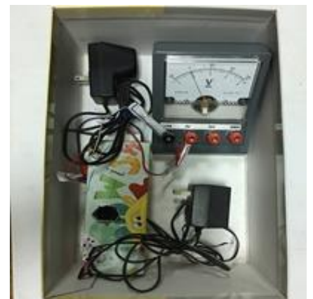
在回收鞋盒內，可整齊擺放全部的吸光儀及伏特計電壓測試器(伏特計可用數位電錶取代之)
