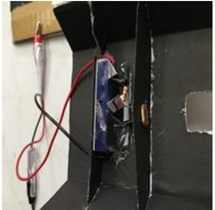
光敏電阻與電阻串接在麵包板上，麵包板貼在雙層黑紙上，並插在上蓋的插槽上，另做一個黑色插板，只露出光敏電阻受光。
