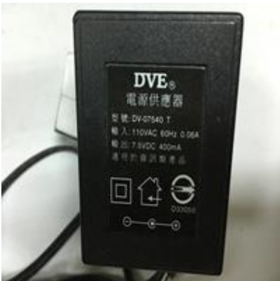
7.5V 3w 燈泡的電源為回收變壓器，可輸出 7.5V 400mA 的功率
