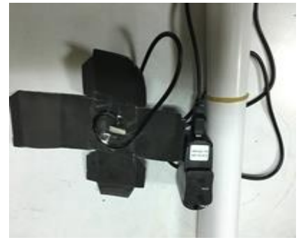
製作光源盒，打洞固定 5V LED 電源 (1 個白光、1 個變色光) 反面
