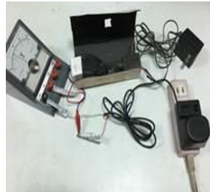
六段式整流變壓器切至 3V 電源，未照光時呈現與光敏電阻串接遮光綠光 LED 的背景電壓
