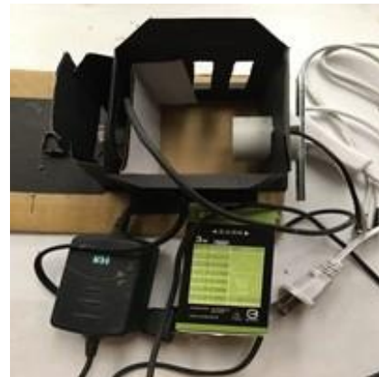
插上光源測試，發現光經凸透鏡折射路徑偏移
