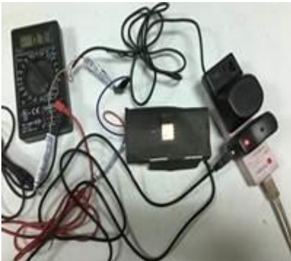
比色管不加蓋，3V 電源下光敏電阻照 5V LED 燈的光感應電壓含 180Ω 電阻及日光燈的背景電壓
