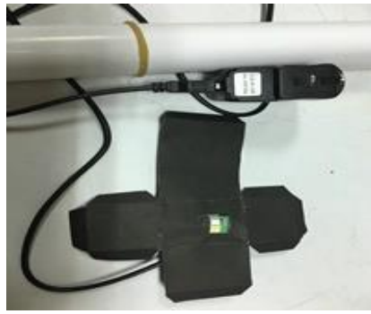
製作光源盒，打洞固定 5V LED 電源 (1 個白光、1 個變色光) 正面
