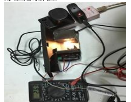
12V 電源下光敏電阻照 5V LED 燈的光感應電壓含背景電壓
