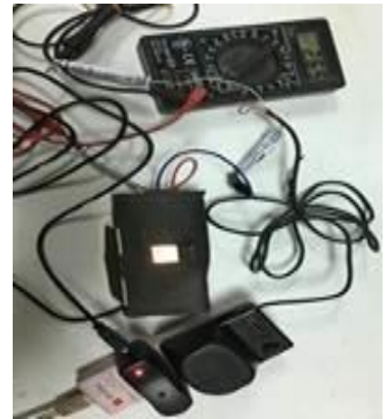
12V 電源下光敏電阻照 5V LED 燈的光感應電壓含 180Ω 電阻及日光燈的背景電壓
