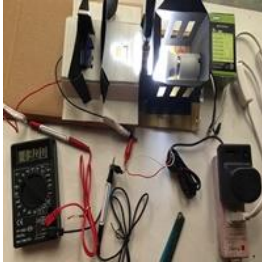
白織 LED 燈光源比色管底盤上提 3 cm 白織 LED 燈光源比色管底盤上提 2 cm 或 1 cm 光敏電阻端的六段式電壓切至 12V 電壓接受光源的照射比較
