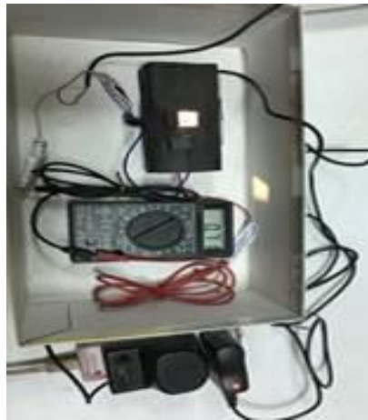
3V 電源下光敏電阻照 5V LED 燈的光感應電壓含 180Ω 電阻及日光燈的背景電壓
