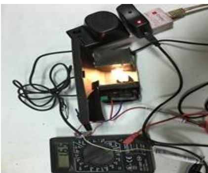
7.5V 電源下光敏電阻照 5V LED 燈的光感應電壓含背景電壓
