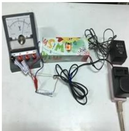
感光路徑盒上蓋闔上，再重新量測光敏電阻在 3~12V 電源下的感光後電壓變化及未感光的各背景電壓
