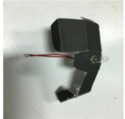
裁片試折後，比對光敏電阻的高度位置，相對應處打 7.5V 3w 燈泡的洞
