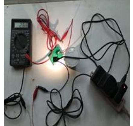
12V 電源下光敏電阻照 5V LED 燈的光感應電壓含 180 \Omega 電阻的背景電壓
