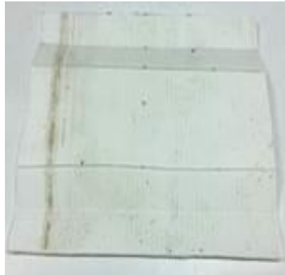
以雙層冷氣封板製作光路徑的可移動式的帽型上蓋，內層加上黑紙完全吸光
