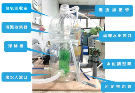
圖6 浮除結構主體設計
