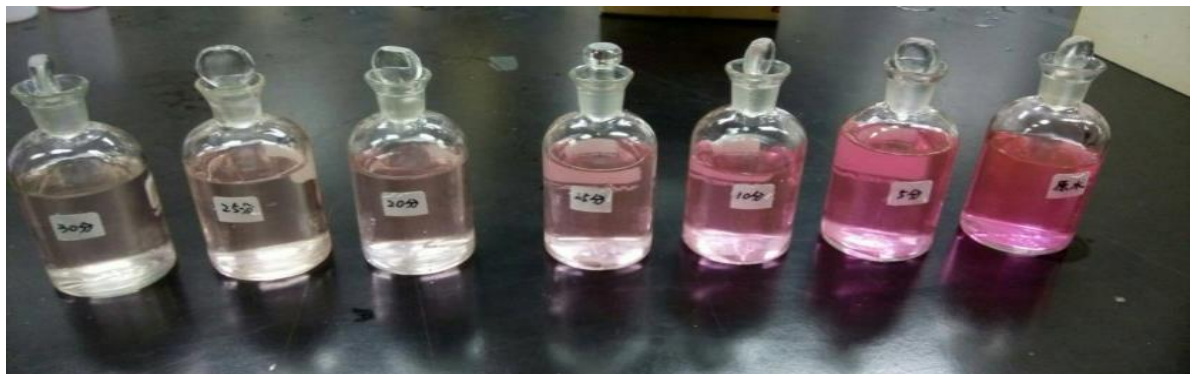
圖 25. O 3 +UV+H 2 O 2 150ppm 實驗結果比較
