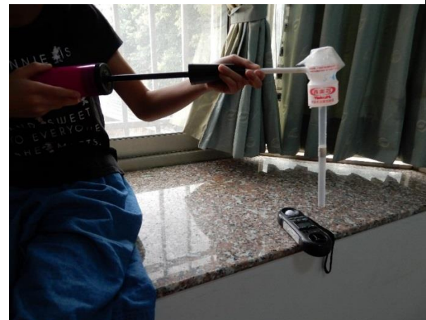
照片 6：樂器出氣孔氣體流速測量
