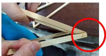
圖二十八之一、30°等腰三角形節點處裂開
