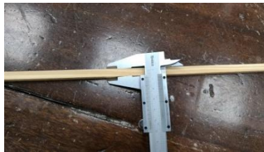
圖八之一、游標尺檢視、確認規格圖
