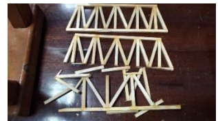
圖四十一、華倫桁架被破壞圖
