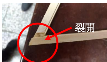
圖二十八之三、60°等腰三角形底邊桿件完全裂開
