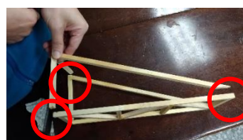
圖二十八之四、直角三角形多數節點的桿件裂開
