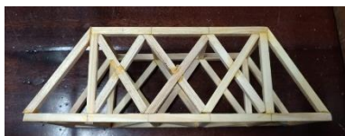
圖四十二、四角華倫桁架承重測試後結構圖
