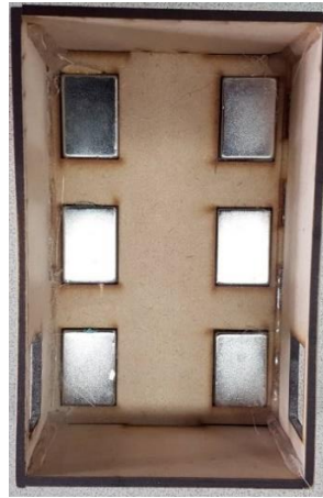
圖 4-21 方形強力磁鐵型車體
