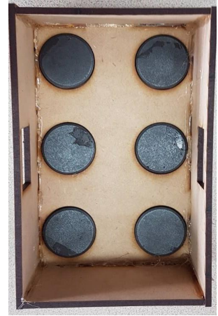
圖 4-22 圓形一般磁鐵型車體
