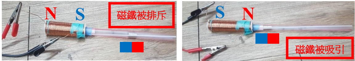
圖 4-9 當兩個電磁鐵測試磁極時強力磁鐵吸斥狀態相同，其磁極方向相同。
