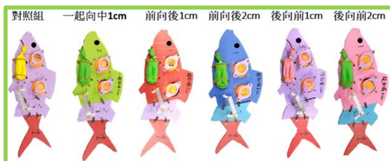
圖 16、研究五-(二) 兩顆浮球間隔不同距離的機械魚
