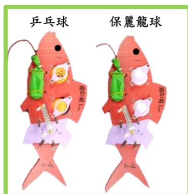
圖 14、研究四 不同浮球材質的機械魚
