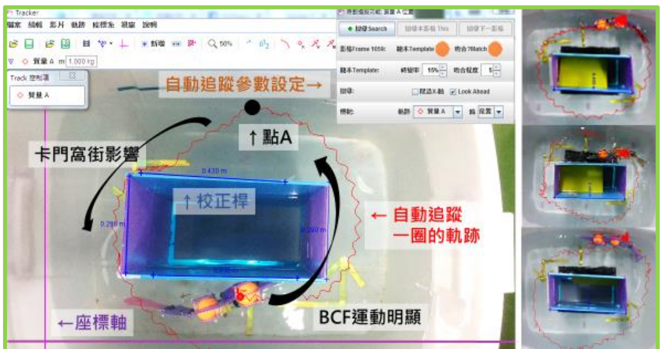
圖 34、使用 Tracker 軟體進行機械魚運動軌跡追蹤
