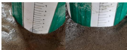
圖二十二：當安置葉片為三角形保護工時的沖刷坑
