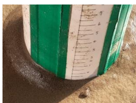
圖二十一：未安置環圈前的沖刷坑
