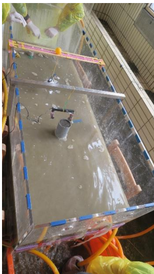
圖十八：感測器位置 圖十九：雷射測距儀測量過程 圖二十：橋墩侵蝕高度測量
