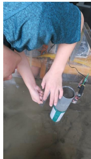
圖十八：感測器位置 圖十九：雷射測距儀測量過程 圖二十：橋墩侵蝕高度測量
