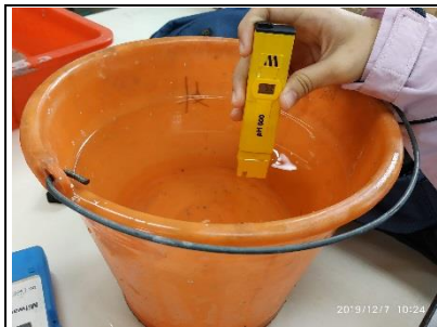
圖4-7-2：倒入少量以稀鹽酸，調製pH=5.5弱酸水。
