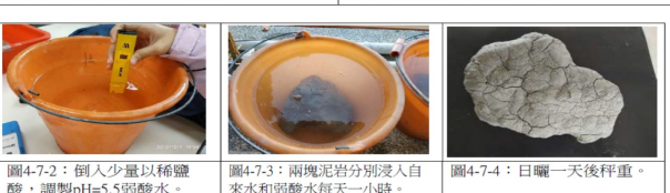
圖4-7-2：倒入少量以稀鹽水，調製pH=5.5弱酸水。 圖4-7-3：兩塊泥岩分別浸入自來水和弱酸水每天一小時。 圖4-7-4：日曬一天後秤重。
