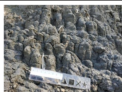
圖1-32-9: 泥岩砂岩混合，產生差異侵蝕，形成土指。
