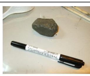
圖4-3-3：取出完全泡入水中10分鐘的小泥塊。
