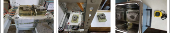
圖6-4：自製的低頻震動。 圖6-5：左邊為低頻；右邊無震動。 圖6-6：利用超音波水分子產生高頻震動。
