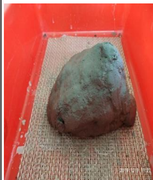
圖3-1-2：浸泡水中一小時後取出，表面成糊狀。
