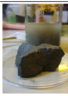
圖4-4-2：中寮隧道北口基岩層的泥塊實驗後
