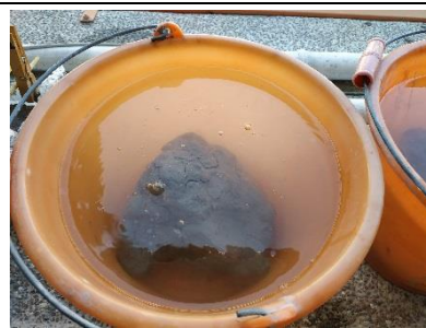
圖4-7-3：兩塊泥岩分別浸入自來水和弱酸水每天一小時。
