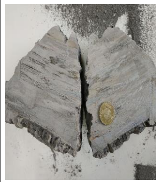
圖3-1-1：以鋼鋸鋸開泥塊，分成等重的兩塊。
