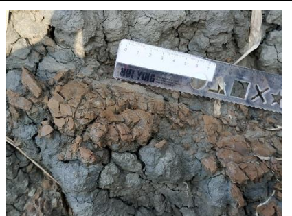
圖1-32-10: 泥岩中處處可見有薄層夾層砂岩。
