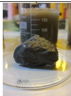
圖4-4-2：中寮隧道北口基岩層的泥塊實驗後
