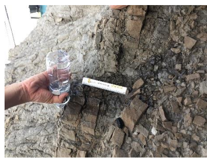
圖1-33-5: 砂岩夾層的節理。
