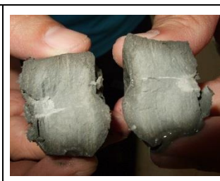
圖4-3-4：敲開泥塊後，只有滲入塊大約1cm左右的深度。
