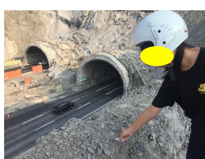
圖1-33-6: 開挖出來的泥岩，滴稀鹽酸，也會產生氣泡，顯示含有碳酸鈣。
