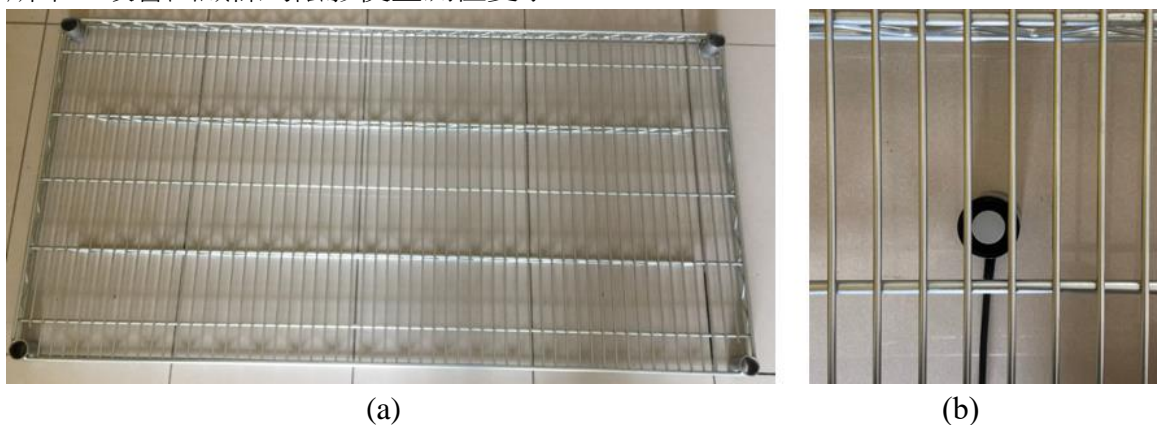
(a) 使用之鐵網置物架(a)與光照計之光感測元件(b)
