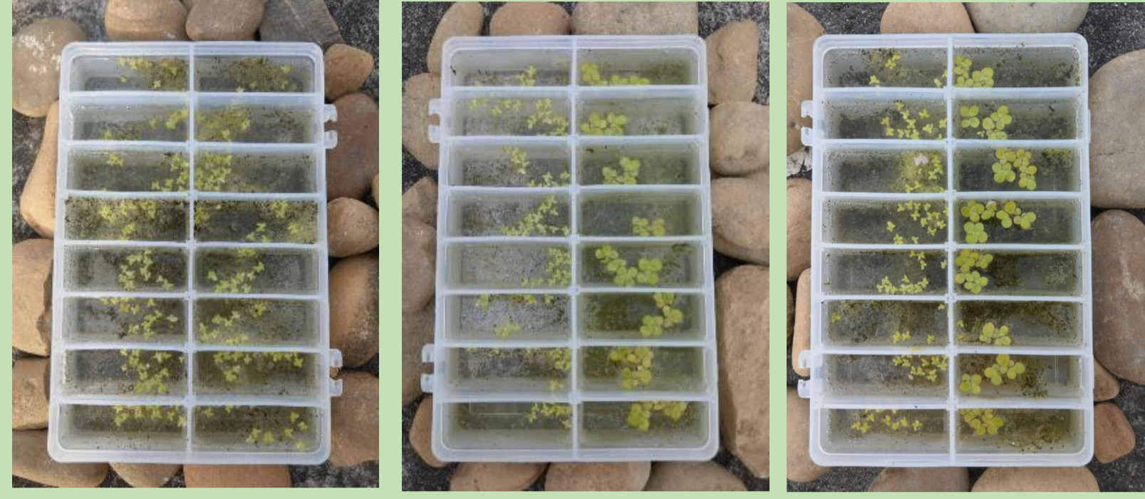
斑馬線式遮蔽50%，架設高度2cm小於最佳高度 斑馬線式遮蔽50%，架設高度8cm等於最佳高度 斑馬線式遮蔽50%，架設高度16cm高於最佳高度
