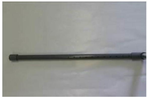
圖 3-10 模擬海水平行流動之出水口
