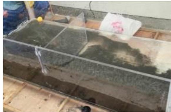
圖 4-7 乒乓球進行流速測試
