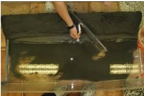
圖 5-36 120 度壩堤實驗後壩前堆積測量
