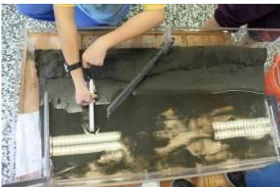
圖 5-20 50 度壩堤實驗後壩前堆積測量
