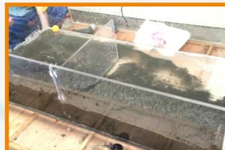
圖4-7 乒乓球進行流速測試
