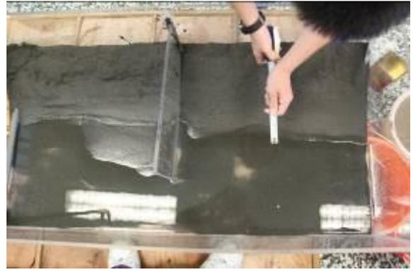
圖 5-29 90 度壩堤實驗後壩後侵蝕測量
