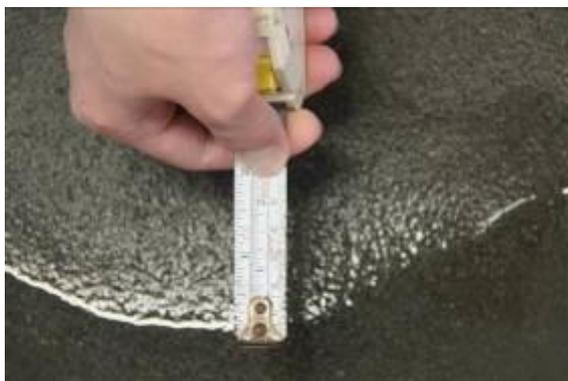
圖 5-17 流速 C 實驗後壩前堆積測量
