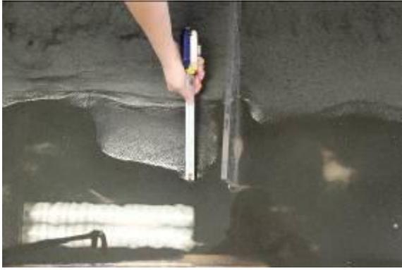
圖 5-28 90 度壩堤實驗後壩前堆積測量
