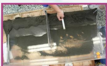
圖5-16 流速C實驗後及壩後侵蝕測量
