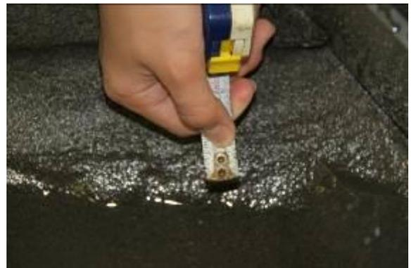
圖 5-37 120 度壩堤實驗後壩後侵蝕測量
