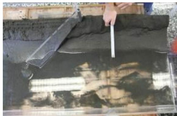
圖 5-21 50 度壩堤實驗後壩後侵蝕測量
