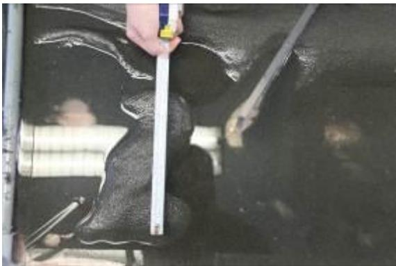
圖 5-24 70 度壩堤實驗後壩前堆積測量
