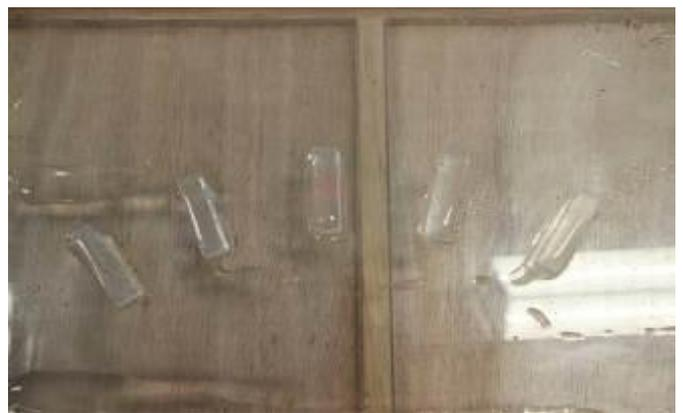
圖 3-2 控制壩堤角度小壓克力塊
