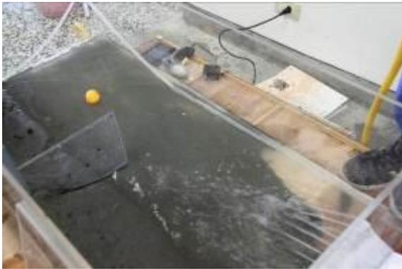
圖 4-6 乒乓球進行流速測試
