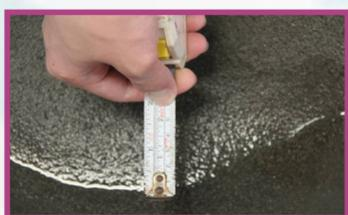
圖5-17 流速C實驗後壩前堆積測量
