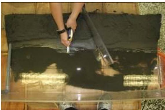
圖 5-32 105 度壩堤實驗後壩前堆積測量
