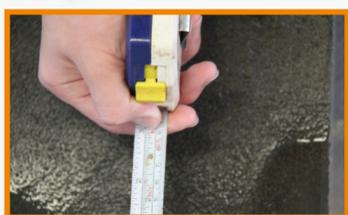
圖5-13 流速B壩前堆積測量
