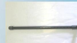
圖3-10 模擬海水平行流動之出水口
