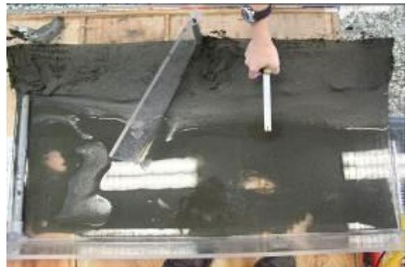
圖 5-25 70 度壩堤實驗後壩後侵蝕測量
