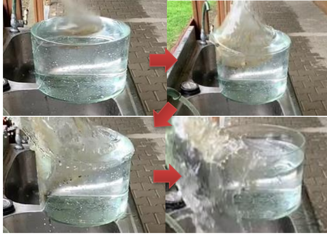
圖 5 土球進入水中測試實驗過程
