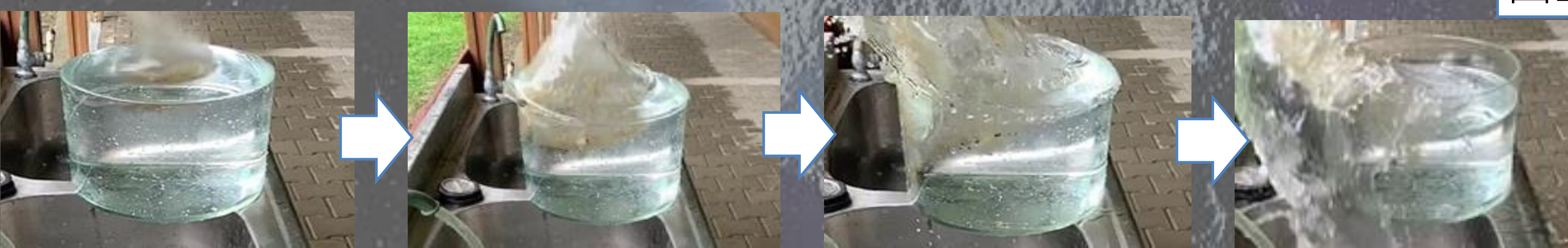
圖19 爆炸模擬實驗過程(固定彈力拉伸距離、沿固定軌道至引爆點)
