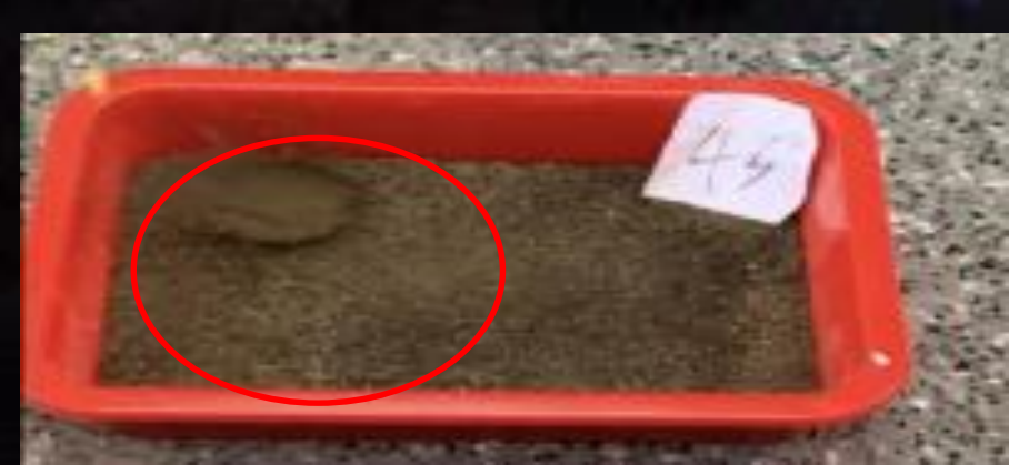
圖13 45度入射撞擊乾燥土壤情形
