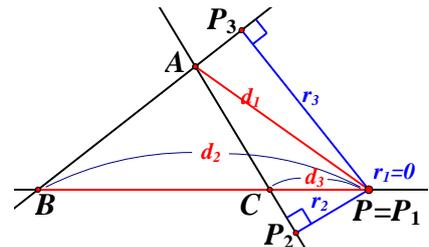
【圖 1.5】三角形內部、外部與邊上一點的三線坐標( $r_1 : r_2 : r_3$ )
