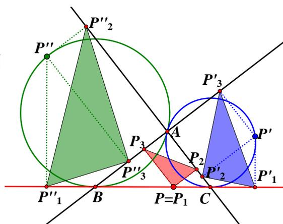
【圖 2.20】第一垂足三角形為直角三角形 ( $\angle A=90^\circ$ 時的反射狀況)
