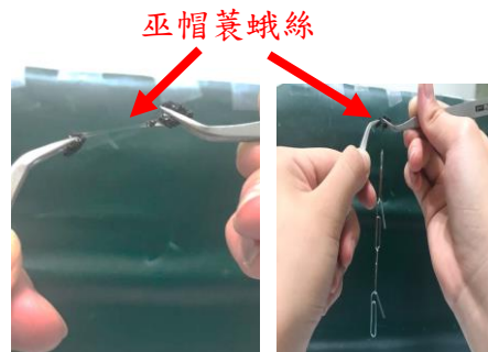
圖 23:以蓑蛾絲、蠶絲、蜘蛛絲，在雙手固定下，測韌性實驗
