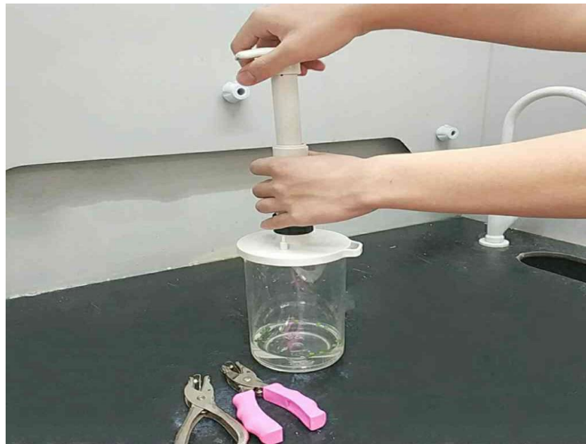
(圖二)抽氣密封罐抽氣使葉錠下沉
