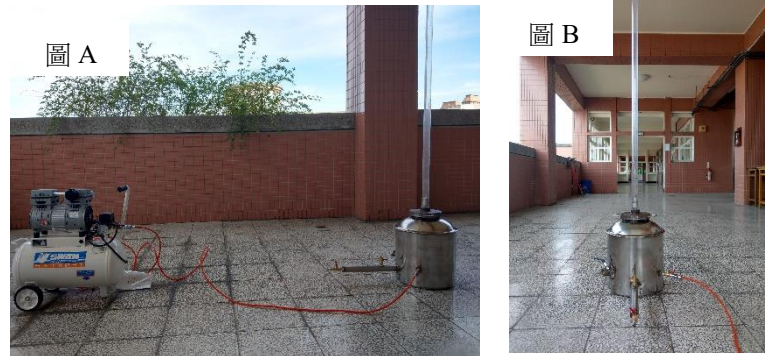
圖 3-4 改良後塵爆裝置
