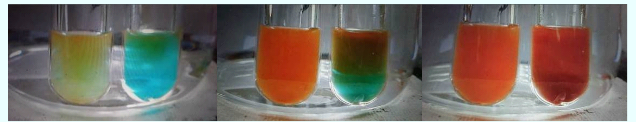
圖5-1、2 M的葡萄糖液與自製(左管)及市售(右管)本氏液反應顏色變化(連續變化影片中擷取圖片)
