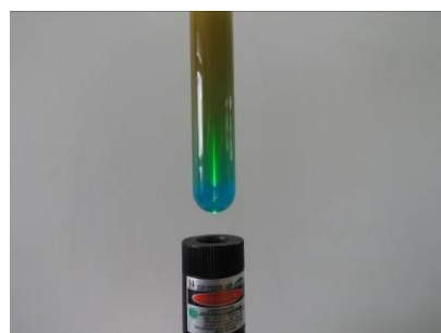
圖 5-10、未混合均勻的中斷反應，用雷射光檢測結果
