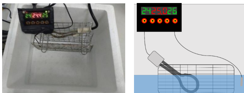
圖 5-4 溫控感測器恆溫水浴槽完成圖及示意圖
