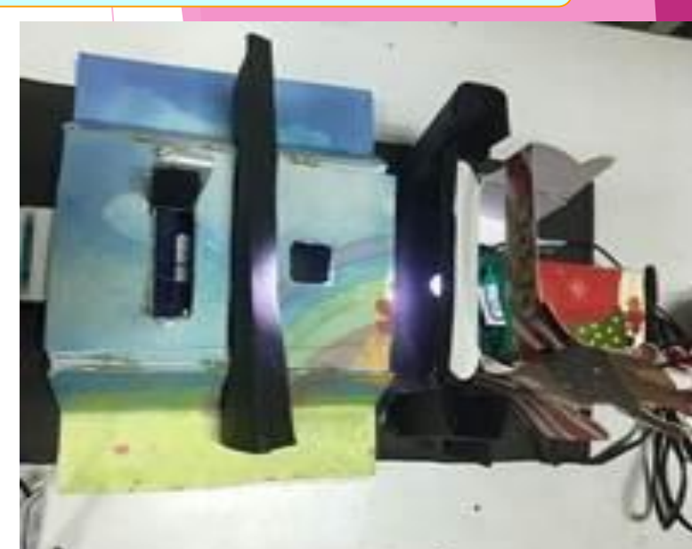
第三代自製簡易吸光儀移動式的感光槽可適度調整最佳的感光路徑
