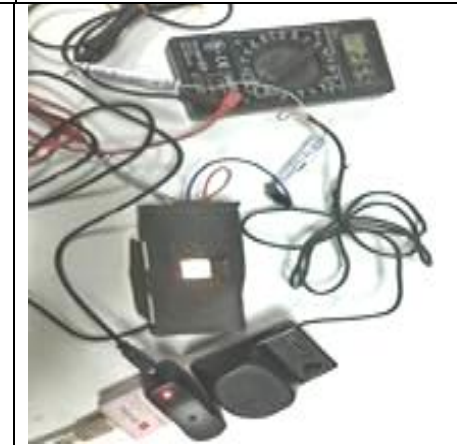
12V 電源下光敏電阻照 5V LED 燈的光感應電壓含 180Ω 電阻及日光燈的背景電壓
