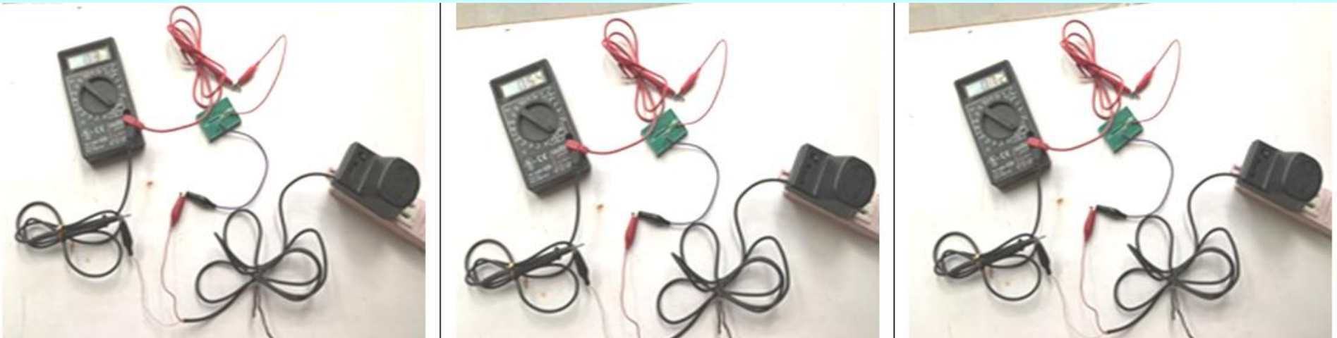
3V 電源下光敏電阻照日光燈的光感應電壓含180Ω電阻的背景電壓 4.5V 電源下光敏電阻照日光燈的光感應電壓含180Ω電阻的背景電壓 6V 電源下光敏電阻照日光燈的光感應電壓含180Ω電阻的背景電壓
