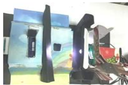
第三代自製簡易吸光儀移動式的感光槽可適度調整最佳的感光路徑
