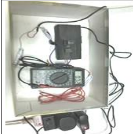
比色管加蓋不照日光的背景電壓值小，只有 0.02V
