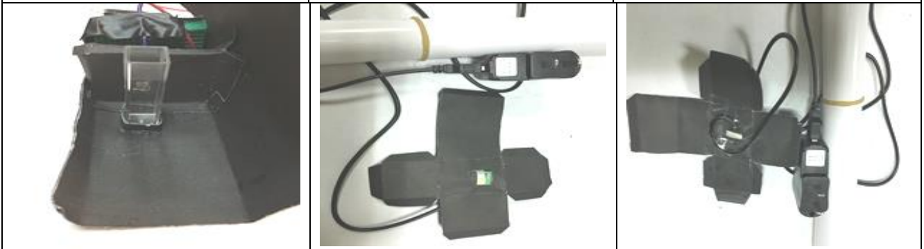
比色管與凹槽放在光敏電阻前的最佳位置上，固定之 製作光源盒，打洞固定 5V LED 電源 (1 個白光、1 個變色光) 正面 製作光源盒，打洞固定 5V LED 電源 (1 個白光、1 個變色光) 反面
