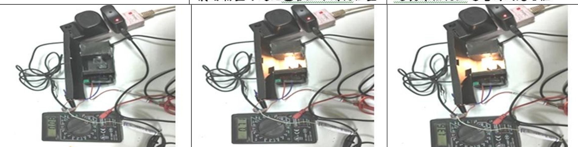
照日光的背景電壓值小,只有0.08V 3V 電源下光敏電阻照5V LED燈的光感應電壓含180Ω電阻及日光燈的背景電壓 6V 電源下光敏電阻照5V LED燈的光感應電壓含背景電壓
