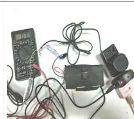
比色管加蓋，3V 電源下光敏電阻照 5V LED 燈的光感應電壓含 180Ω 電阻及不含日光燈的背景電壓
