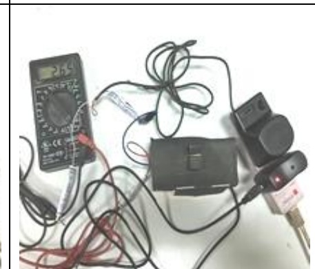
比色管加蓋，12V 電源下光敏電阻照 5V LED 燈的光感應電壓含 180Ω 電阻及不含日光燈的背景電壓
