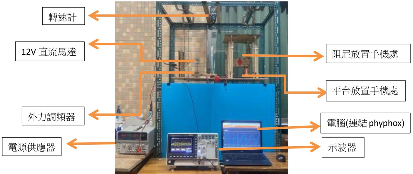
圖 21 地震晃動平台之實驗裝置器材示意圖
