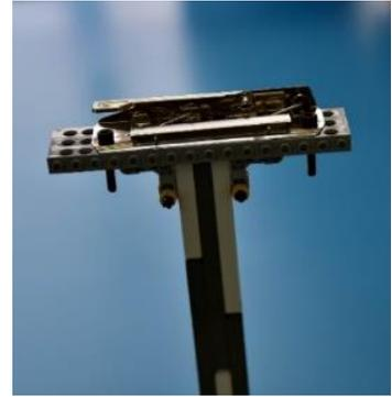
圖 3. 我們使用強力夾模擬握索器，將吊臂固定在纜繩上
