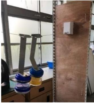
圖 2. 利用爆米花筒製作出車廂，與鋁合金吊臂接合後，懸掛於纜繩上。
