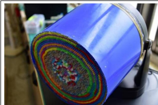
圖 13. 塑膠桶搭配吸管製作的整流段
