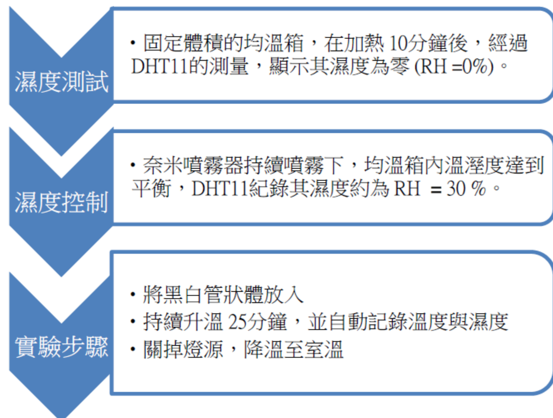
圖6 均溫箱在濕度狀態下(RH = 30%)實驗步驟簡易流程圖
